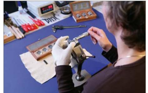
Die kalibrierten Messmittel werden durch Einölen oder mittels Vaseline konserviert und sachgemäß verpackt bzw. in Schmelzmasse getaucht. Die stoßgeschützte Verpackung erfolgt direkt im Versandraum des Kalibrierlabors. Kalibrierscheine können in Papierform, als PDF per E-Mail oder direkt online über KalimeroNet zur Verfügung gestellt werden.
