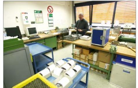
Die Kalibrierung der Messmittel erfolgt nach VDI/VDE/DGQ-Richtlinie 2618 ff. „Ü“ (Überwachungsprüfung). Messmittel, welche nicht den Spezifikationen entsprechen, werden mit einem „gesperrt“-Aufkleber versehen. Prüfplaketten werden auf Wunsch angebracht. Messmittelstammdaten und Kalibrierscheine werden auch in unserer Online-Datenbank abgelegt (Kalibrierscheinmuster siehe auch Seite 32).
