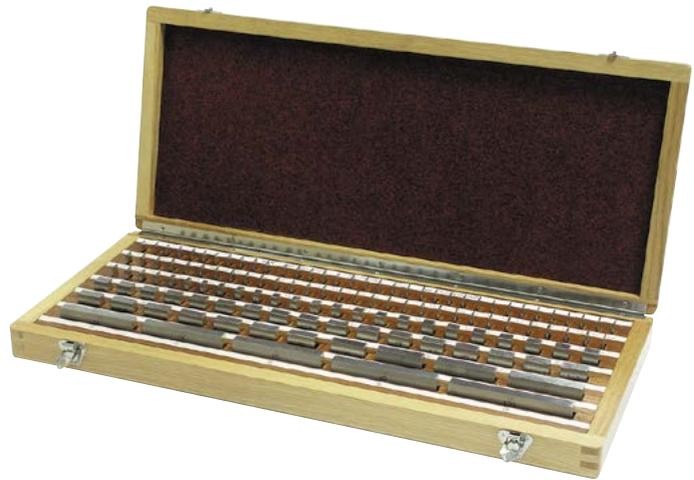
**Einzel-Parallelendmaße nach DIN EN ISO 3650, Gen. 0, 1 oder 2 aus Stahl, Hartmetall oder Keramik**
