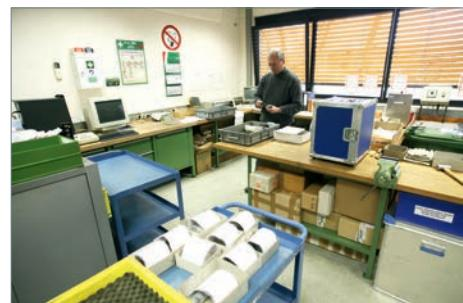
Die Kalibrierung der Messmittel erfolgt nach VDI/VDE/DGQ-Richtlinie 2618 ff. „Ü“ (Überwachungsprüfung). Messmittel, welche nicht den Spezifikationen entsprechen, werden mit einem „gesperrt“-Aufkleber versehen. Prüfplaketten werden auf Wunsch angebracht. Messmittelstammdaten und Kalibrierscheine werden auch in unserer Online-Datenbank abgelegt (Kalibrierscheinmuster siehe auch Seite 28).
