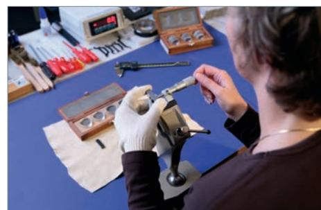
Die kalibrierten Messmittel werden durch Einölen oder mittels Vaseline konserviert und sachgemäß verpackt bzw. in Schmelzmasse getaucht. Die stoßgeschützte Verpackung erfolgt direkt im Versandraum des Kalibrierlabors. Kalibrierscheine können in Papierform, als PDF per E-Mail oder direkt online über KalimeroNet zur Verfügung gestellt werden.
